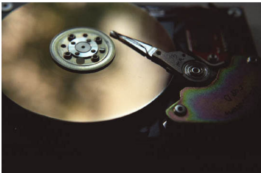
Slika 6. Izgled unutrašnjosti hard diska
